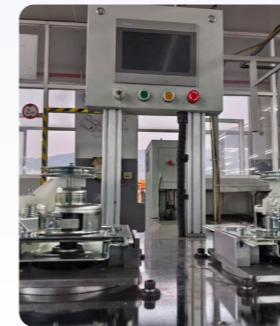
制动力矩和反向力矩一体化自动检测
