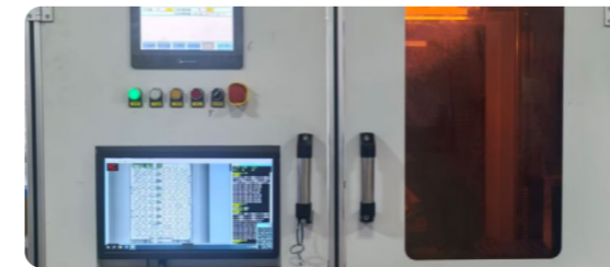
某系列汽车高相似度零件防混自动检测
