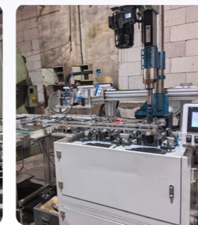
安装板自动化攻丝铰孔设备
