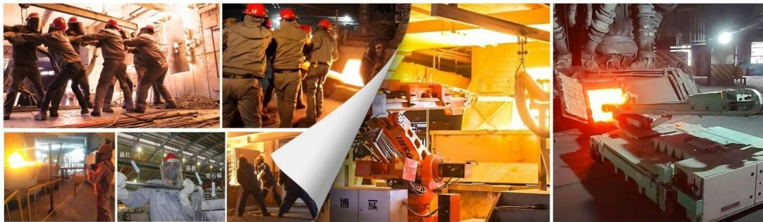
图示：针对电石矿热炉领域出炉机器人、捣炉机器人替代人工作业示意图
