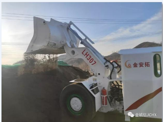
自研电动铲运机 低噪音 无尾气
