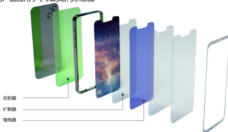
公司产品应用于手机的结构示意图
