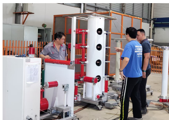
巴拉圭, Transour, 400kV40kJ 冲击设备现场
