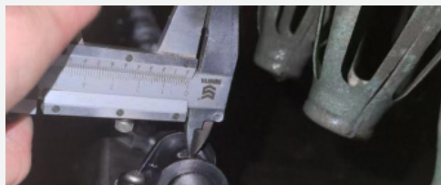
优化喷淋水管管径
