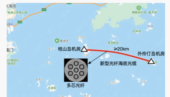
• 桂山岛 - 外伶仃岛空分复用光纤海缆线路
