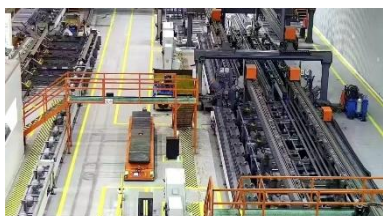
输电铁塔角钢智能柔性加工系统
