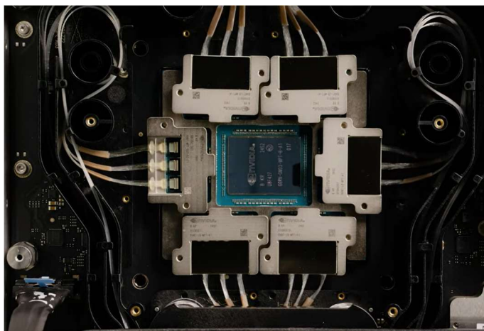
图 12：CPO 内部结构
