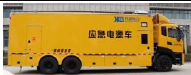
锂电 UPS 电源车
