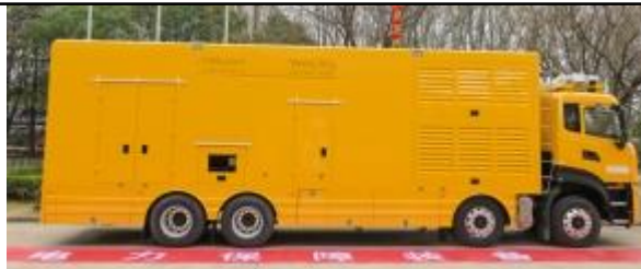
1600kW 一体式中压电源车
