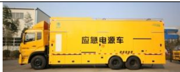
混合 UPS 电源车
