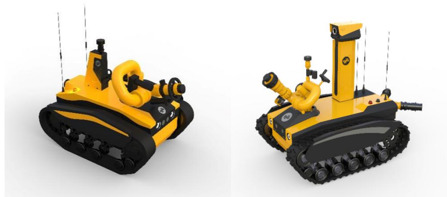
消防灭火机器人
