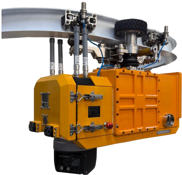
图：矿用隔爆兼本安型巡检机器人
