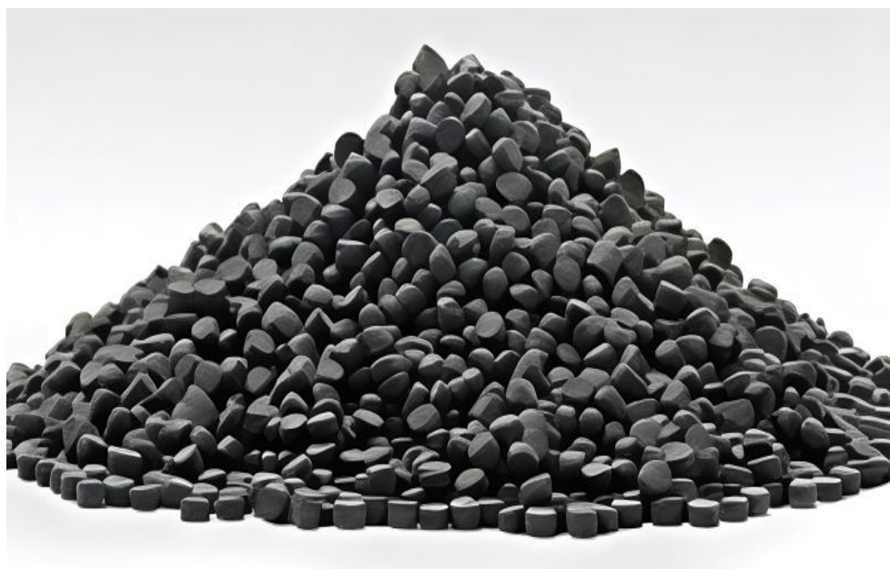
图：金属注射成型喂料实物图
