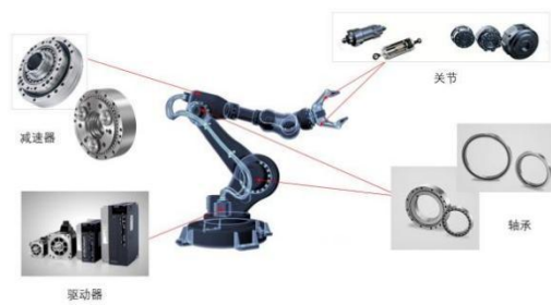
工业机器人 40%~50%的零部件需要进行热处理
