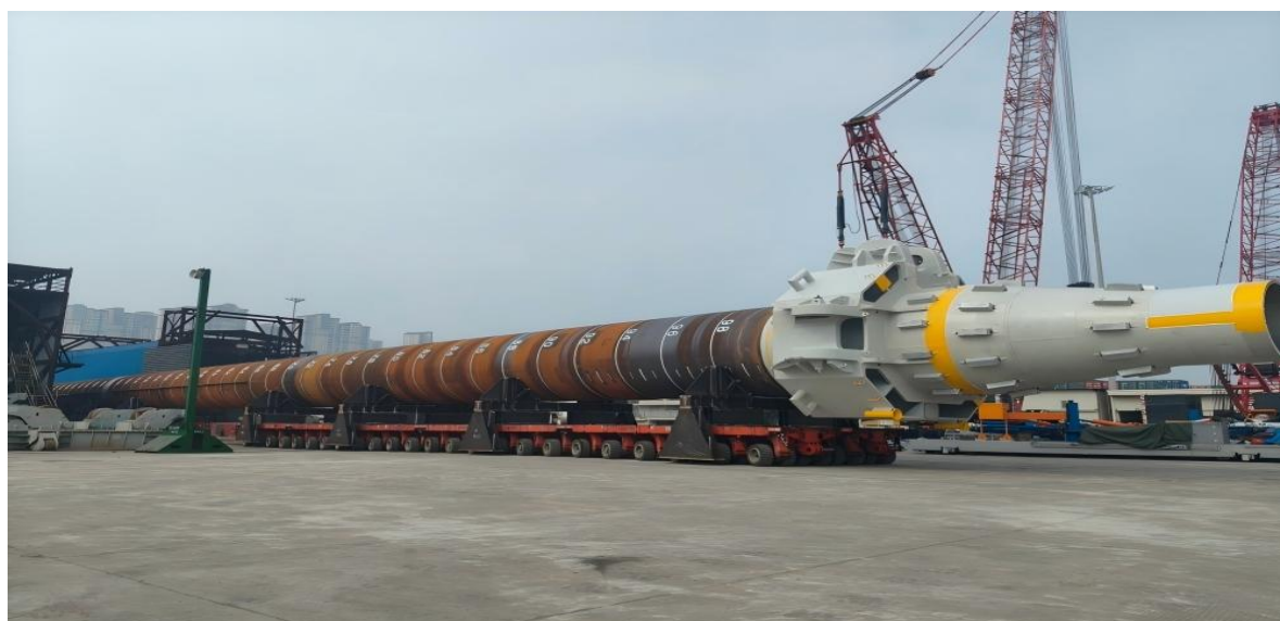
图示：16 兆瓦张力腿深远海浮式风电平台锚桩
