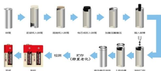
(2) 公司的碳性电池产品的工艺流程如下图所示：
