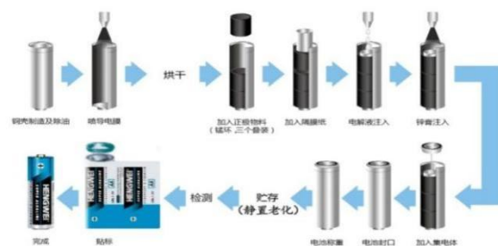
(2) 公司的碳性电池产品的工艺流程如下图所示：
