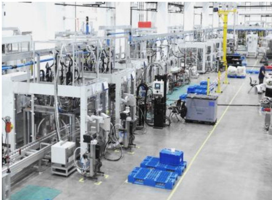
图：三合一电驱的装配和测试系统
