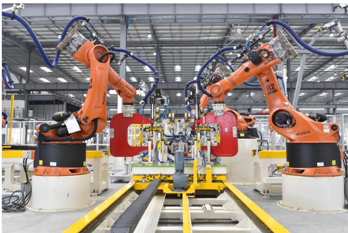
图：FDS、SPR连接工艺应用于产线中
