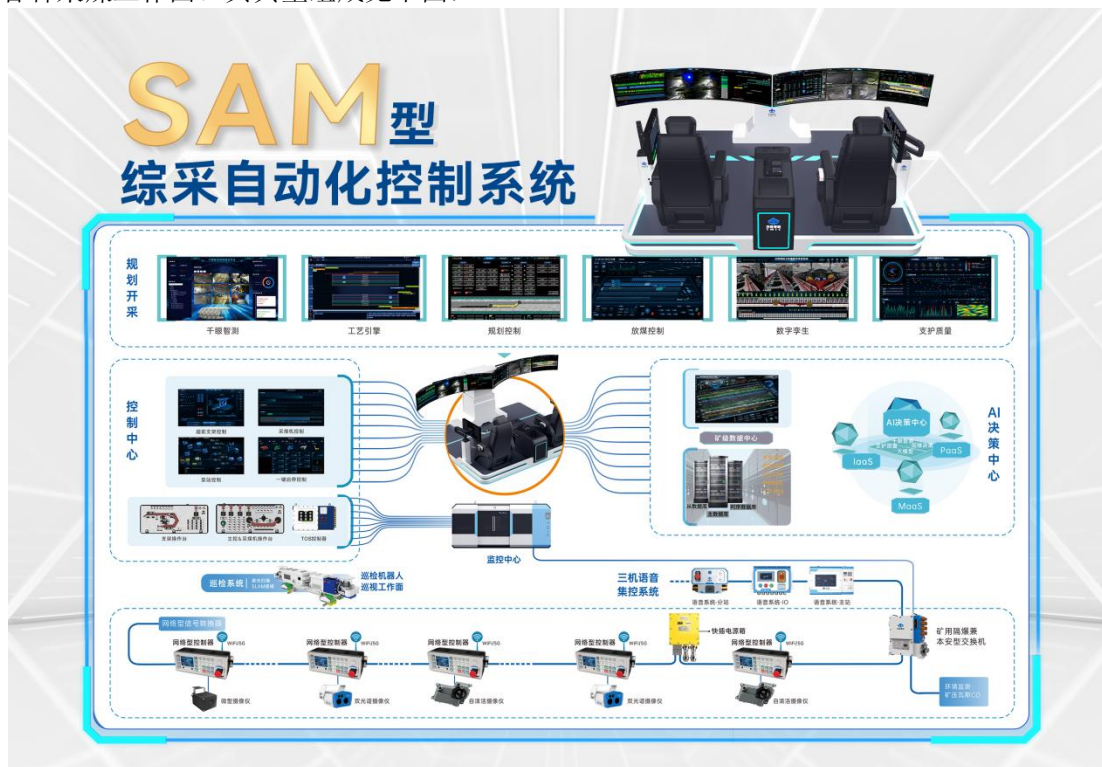
SAM 型综采自动化控制系统是以工业环形以太网连接地面调度监控中心和井下顺槽监控中心，集成自主规划截割子系统、液压支架电液控制子系统、智能视频监控分析子系统、数字孪生子系统及智能集成供液子系统等工作面设备子系统，形成的成套装备智能控制核心系统，具有高可靠的扩展能力，通过友好、便捷的人机交互方式实现井上决策工作面采煤工艺、可视化调控，井下设备依据决策自动执行。该系统能够满足薄煤层、中厚煤层、大采高及放顶煤等不同类型工作面的智能化应用需求，满足不同类型自动化设备和协同联动智能化要求，可根据客户的不同需求提供针对性解决方案。
