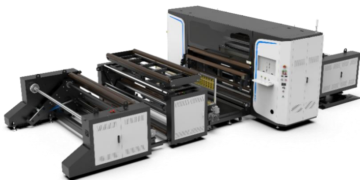
“卷对单”模式瓦楞彩箱数码印刷机
