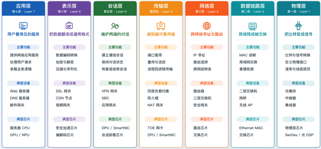
图 OSI 七层网络模型
