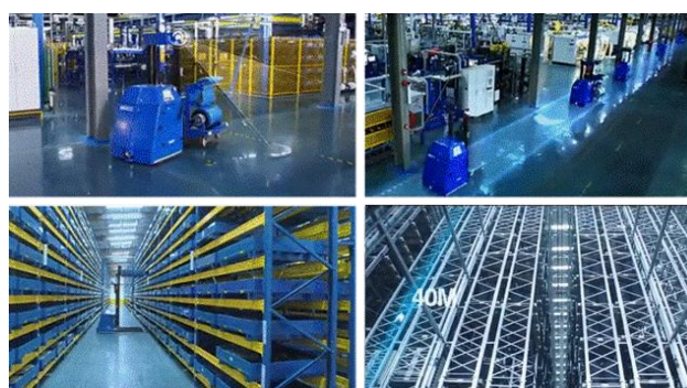
AGV（自动导引运输车）应用及自动化立体仓库示意图
