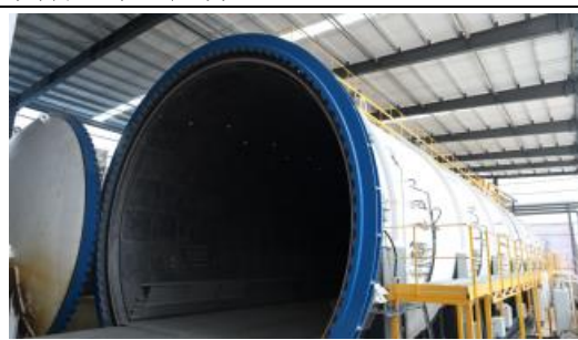
复材大型热压罐（8 米×36 米）
