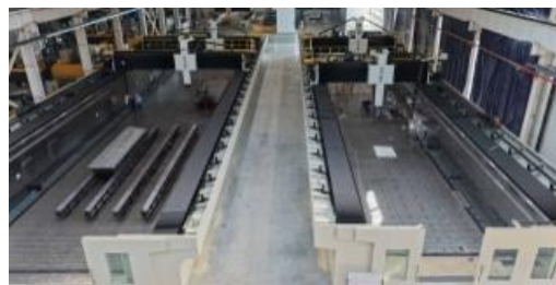
五坐标桥式双龙门镗铣床 (40米×5米×1.8米)
