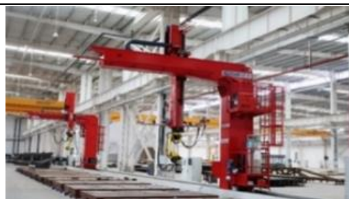
机器人自动焊接站 (35米×4米×4米)
