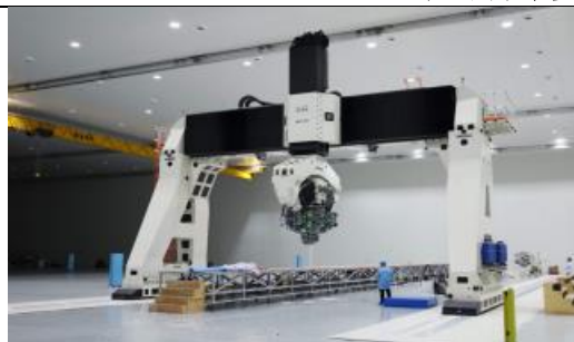
龙门结构自动铺丝铺带一体机(41 米×8 米)
