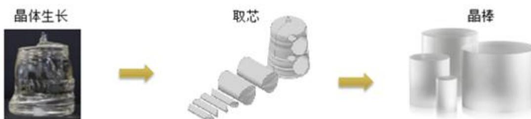
晶体生长过程主要包括引晶、放肩、等径生长三个步骤，奥瑞德通过优化流程时间分配，着重改善放肩、退火工艺，优化晶体形态的同时缩短晶体生产时间，提高晶体的利用效率。另外，奥瑞德通过不断研发，模拟计算最优晶体利用比例，在增加少量工艺时间的情况下，大幅度提高蓝宝石毛坯重量，并通过严密的流程监控、完善的设备维护、先进的加工技术以及协调的人力配置等精细化管理流程保证晶体质量，进而大大提高晶棒产出，降低单位产品的能耗、人力、设备等成
