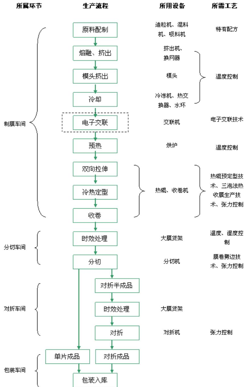
注：上述流程中，收卷后产生的产品为大卷热收缩膜，大卷热收缩膜在进行时效处理后，公司将根据客户订单要求的宽度和款式（单片或对折），进行裁剪或对折，最终生产出入库成品。
