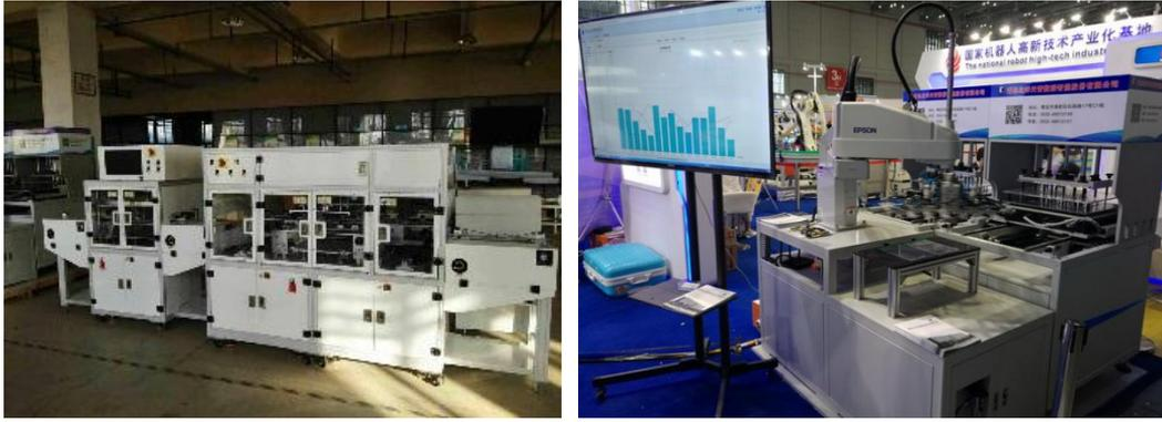
在测试系统集成领域，北洋天青致力于 PCBA 自动测试设备的研发，报告期内主要产品为电控板 ICT+FCT 自动测试线。该产品综合了机器人自动上下料技术、机器人视觉校正技术，高速数字信号采集、模拟信号采集、计算机图像分析技术和数据库技术等，可以替代传统的人眼检测，实现对电控板功能和性能的全自动测试，消除人为因素，保证产品质量的稳定性。
