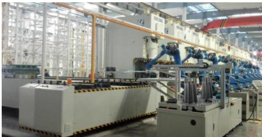
模具立体库自动换模系统结合了自动换模技术、立体库技术和信息化技术，该系统主要集成设备有换模车、模具转运台车、旋转台车、推拉机构、过渡台、压机过渡架组件、锁夹模系统、模具立体库及重型堆垛机等。该系统可以完成行业注塑模及冲压模等模具的存放、调度和自动更换，可以根据产品定义相关模具更换配方从而实现一键快速换模功能，解决模具存放与更换难、耗时长、换模困难、效率低等问题，减轻工人劳动强度，提高生产效率。
