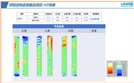
图：外墙实测机器人出具外墙云图数据
