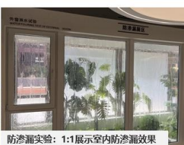
防渗漏实验：1:1展示室内防渗漏效果
