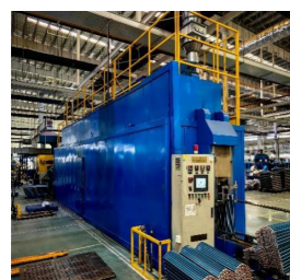
真空脱脂替代燃气脱脂
