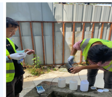
在线设施监测污水实时排放
