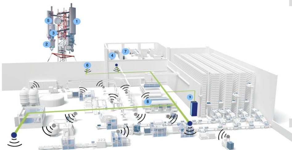
无线基站室外部分 (天线, 塔放, 射频拉远单元等)
