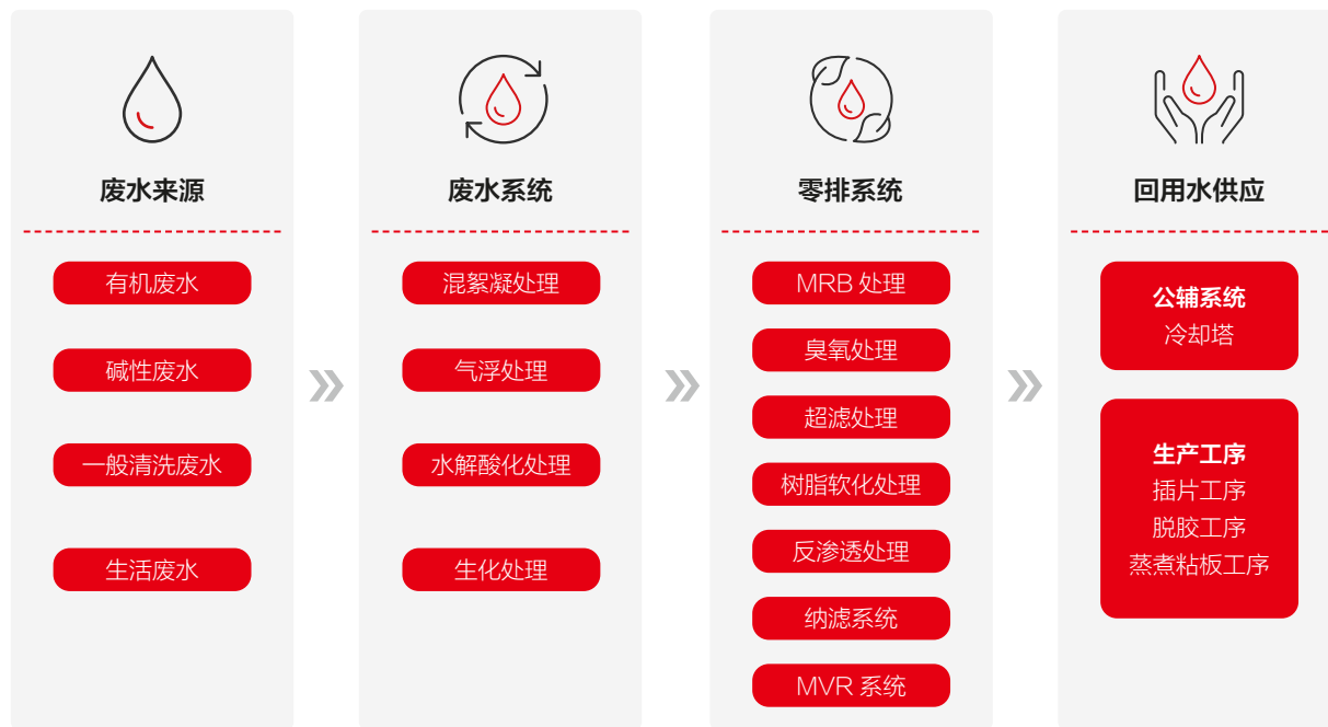
环智新能源废水回用系统流程图
