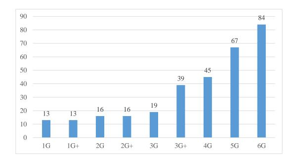
图表 6 滤波器需求随射频频段增加而增多
