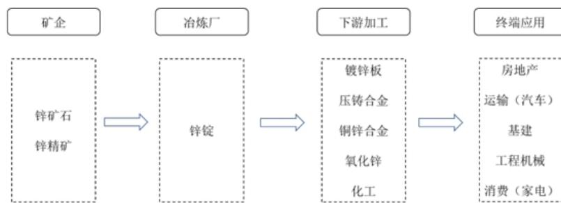
有色金属冶炼，是指从复杂成分的矿物骨料中提取金属，以得到金属原料，并完成有色金属的粗加工，最终通过原金属的清洗，获得更加精炼的金属产品。冶金的技术通常分为火法冶金、湿法冶金和电冶金三大类。
