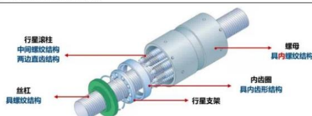
行星滚柱丝杠及相关构造拆解
