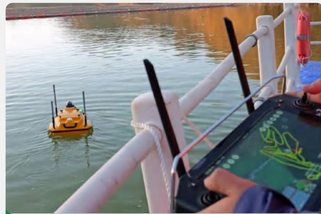
中国区尾矿库引进“智能无人船”，可以精密测量出尾矿库全域的不同水深，准确计算库区水储量，显著提升尾矿库日常管理的效率和精准度。
