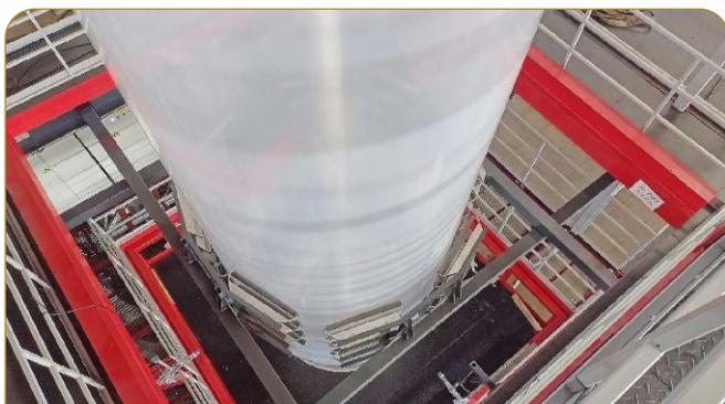
金明自主研发精密型自动风温控制风环，风口风量可根据工艺需求调整，配套欧洲产薄膜自动厚度控制系统，实时检测薄膜厚度趋势并在线反馈调整，高效提产。
