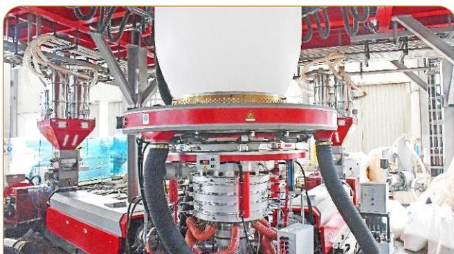
金明通过自主研发，为三层共挤薄膜吹膜机组带在线纵向拉伸装置配套了全新设计的挤出系统及双金属螺杆，具备高产出、低能耗和优良的塑化性能。
