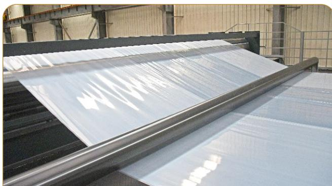
金明研发自制3600中心翻转架卷取收卷机，采用机械式收卷轴，适用于八折卷曲收卷，最大收卷直径 $\phi 500\text{mm}$ 。
