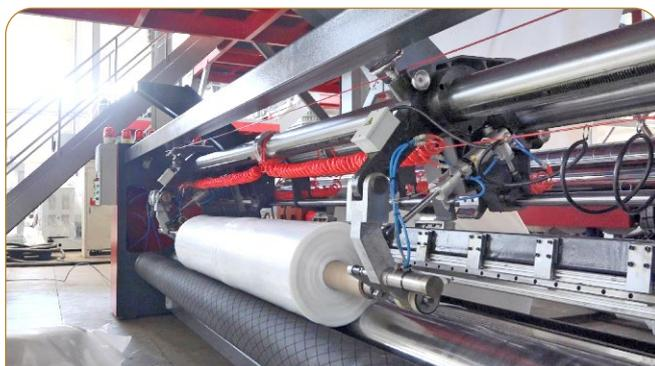
金明研发自制4500III农膜专用全自动收卷机，具有多种收卷功能，可适应多种不同特性材料的卷取，最大收卷直径 $\phi 1000\text{mm}$ 。
