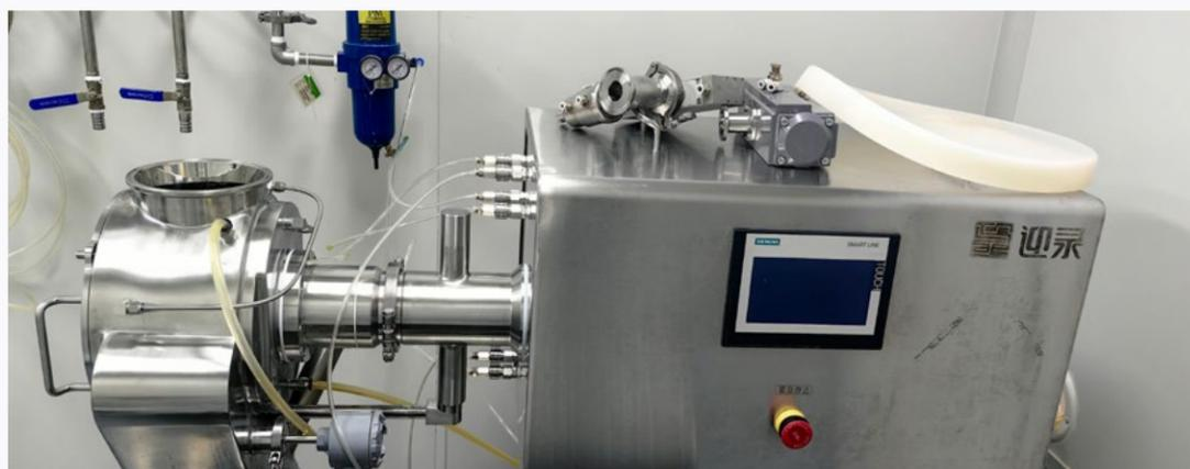
上药信谊万象在固体制剂车间粉碎间更换了锤式粉碎机，该设备噪音小，8h 等效声级 80，自带粉尘过滤及冷却系统。
