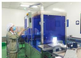
2024 年，北元分厂粉针一车间全自动灯检机正式投入使用，该设备通过 AI 视觉识别技术，自动识别药品中的异物、杂质等不合格品，并精确剔除。同时，为加快设备自动化升级，北元分厂还把“智能化提升，缓解结构性缺员”作为年度 A 类重点工作全力推进，通过立项、破题、解题，集合分厂各类人才优势，加大资金支持力度，全力推动设备自动化水平提升。
