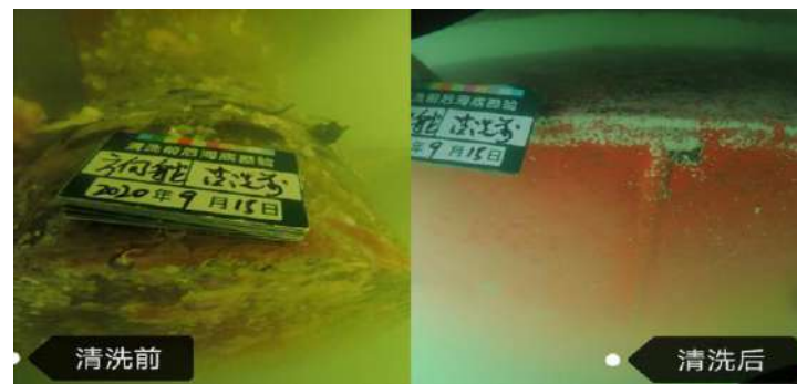
船底低压空化射流清洗
