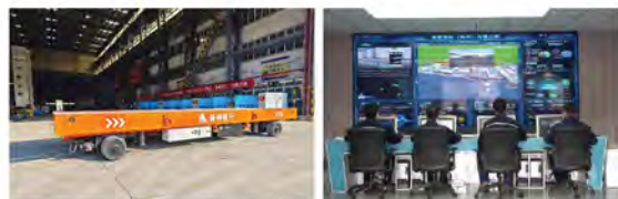
公司所属中铁宝桥扬州公司5G工厂电动升降移动平台和智能数据分析平台
