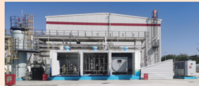
100Nm 3 /hPEM电解水制氢装置成套撬装设备
