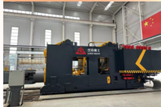
400kN1200kN.m质量分离重载锻造机器人
