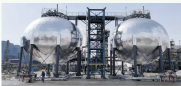
公司承制的新疆广汇能源碳科技公司1000m 3 液体CO 2 球罐
