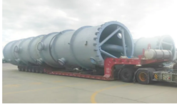
公司承制的伊吾氢能环保科技有限公司绿电耦合焦炉煤气资源综合利用项目变换炉
