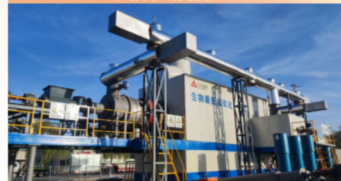
生物质(生活垃圾)低温炭化气化制绿氢成套技术及装备
