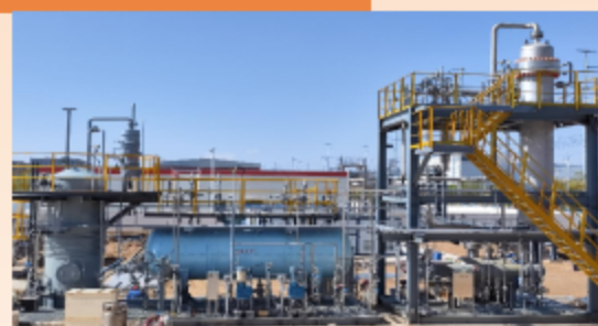
温和氨分解制氢撬装装置
