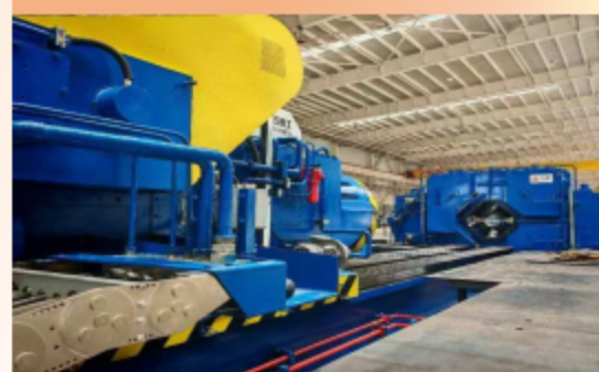
机械式高效精密数控径向锻造机组
