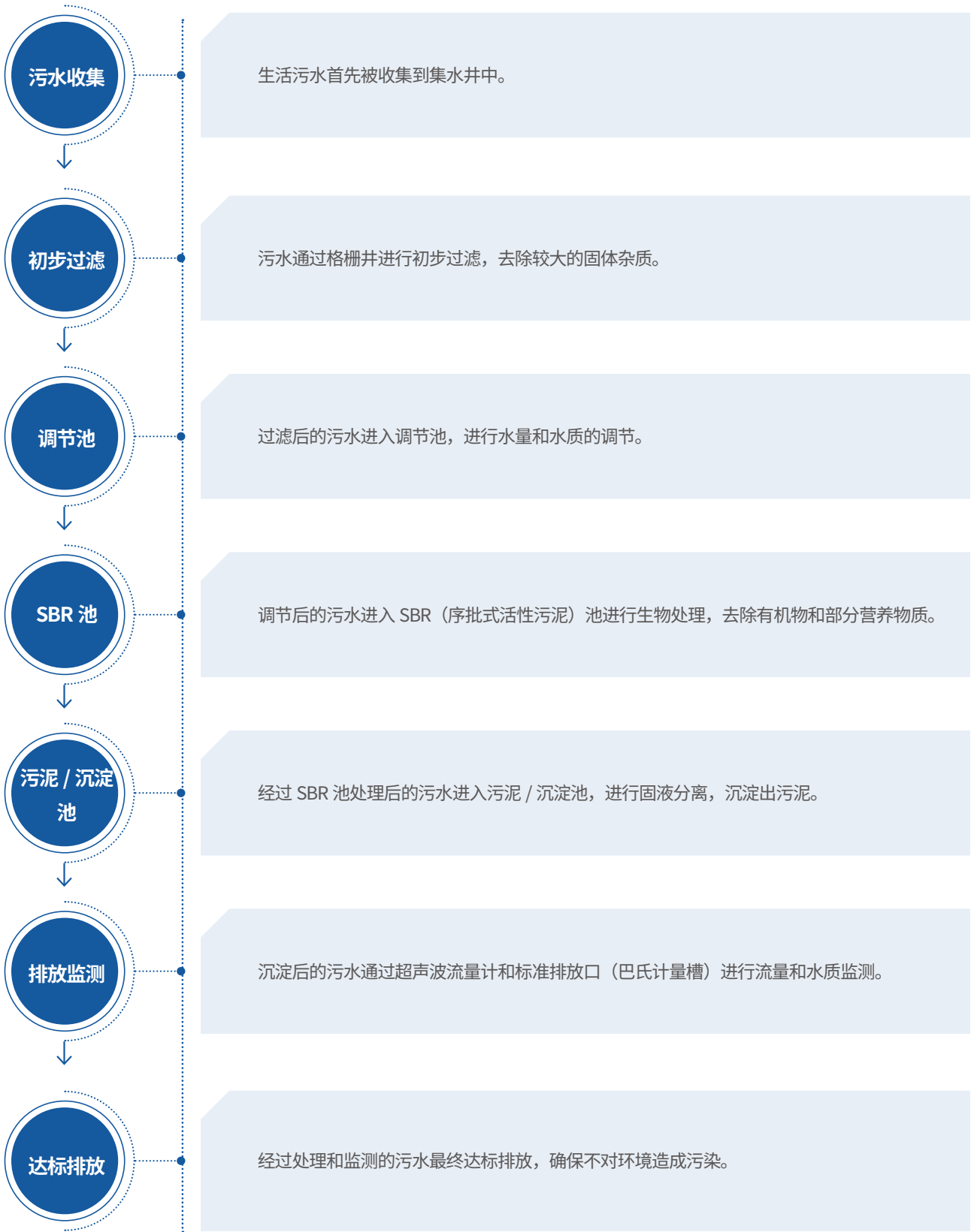
一体化污水处理流程
