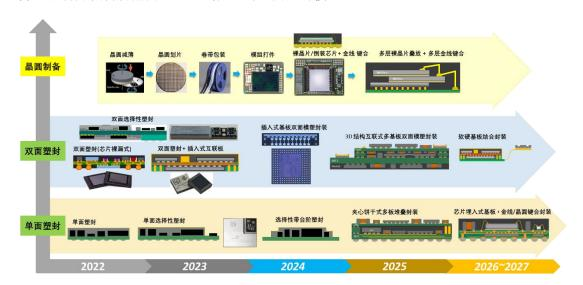
MCC 微小化创新研发中心的推出突破性的 SiP 双引擎技术平台,通过以 Transfer Molding 为主的高密度集成技术满足大规模、高度整合且追求极致微小化模块需求;同时以 Vacuum Printing Encapsulation 为中心的高度弹性技术为模块封装提供了创新的方法,透过在真空腔体中以液态封胶印刷方式实现塑封而不需要定制模具,开发周期能够大幅缩短,故而此创新解决方案可针对不同的市场应用进行快速模块化设计。
