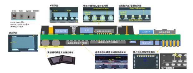
(3)选择性塑封、插入式互联、薄膜辅助模塑直接漏出锡球以及利用铜柱取代 BGA 植球达成高密度连接接口等技术为 SiP 互联、后续工艺提供多样化支持。
