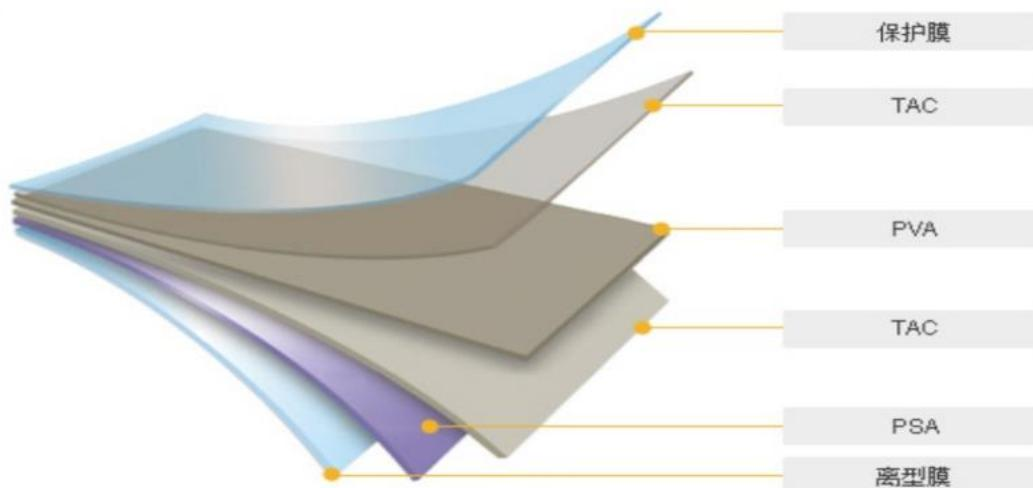
偏光片中起偏振作用的核心膜材是 PVA 膜。PVA 膜经染色后吸附具有二向吸收功能的碘分子,通过拉伸使碘分子在 PVA 膜上有序排列,形成具有均匀二向吸收性能的偏光膜,其透过轴与拉伸的方向垂直。PVA 膜拉伸及碘分子排列情况如下表所示:
