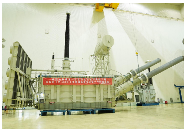
自主研发成功陇东-山东特高压直流输电工程±800kV 高端换流变压器
