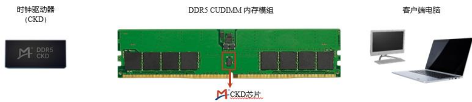
图：CKD 芯片及含 CKD 芯片的 CUDIMM 内存模组示意图
