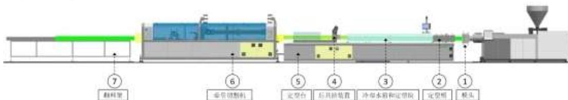
上图中①②③④为塑料挤出成型模具、挤出成型装置，⑤⑥⑦为下游设备，公司主要产品具体如下：
