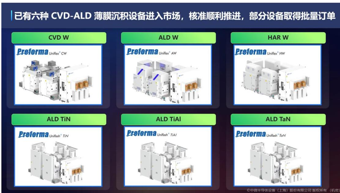
公司的薄膜沉积设备采用独特的双腔设计，每个腔体可独立进行工艺调节，保证产品性能的同时，大大提高了生产效率，降低了材料成本。此外，中微独立自主的 IP 设计，确保了更优化的产品性能，也保障了产品未来的可持续发展。
