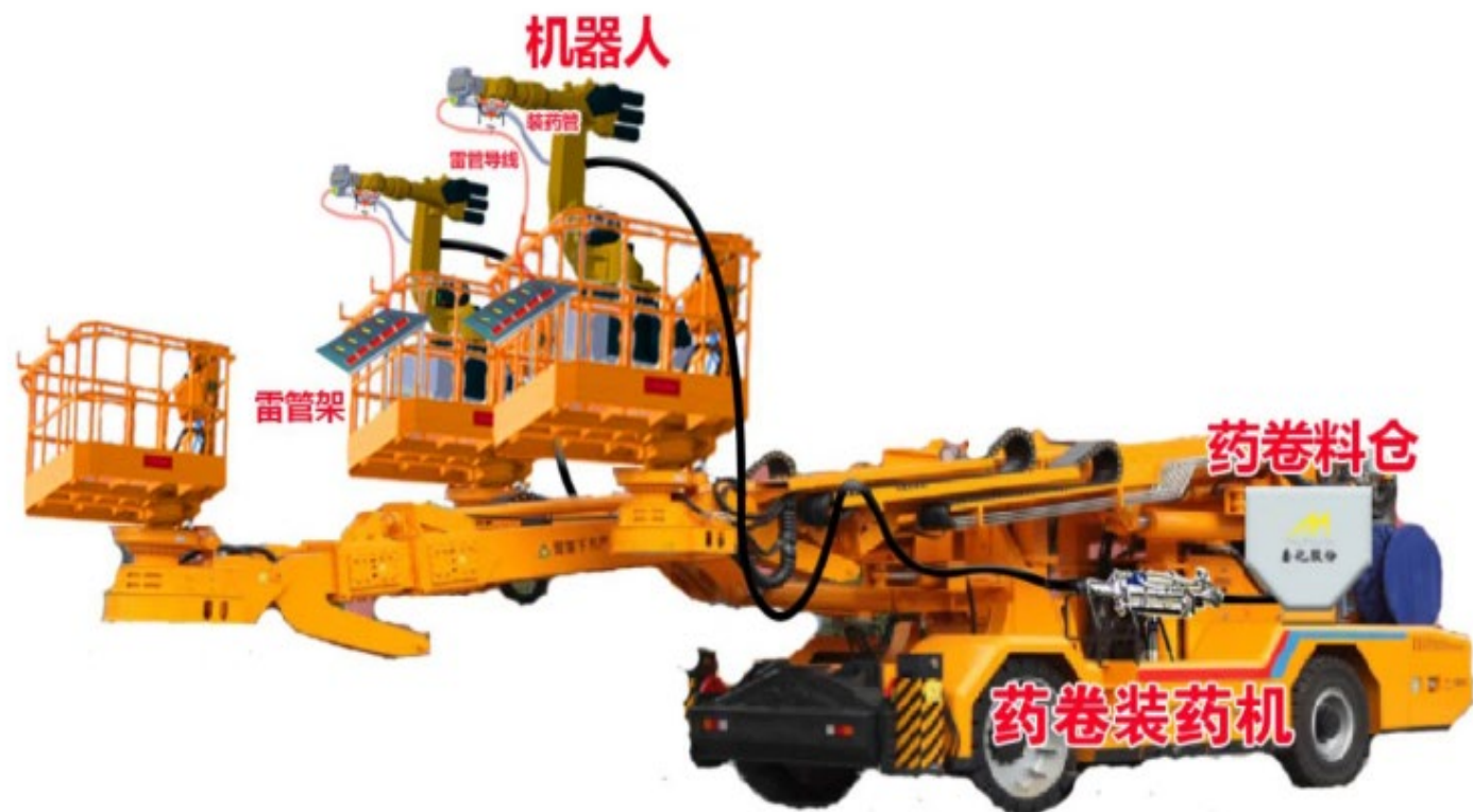
隧道爆破智能装药机器人
