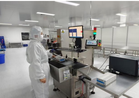
使用药品追溯系统进行生产赋码
