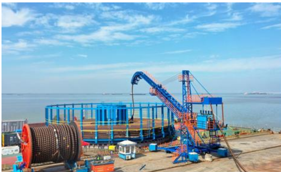
图：中东油气项目三芯 230kV 交流海缆顺利交付
