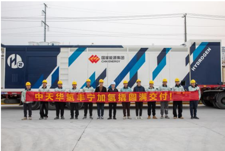
图：中天华氢 35MPa 移动式加氢设备
