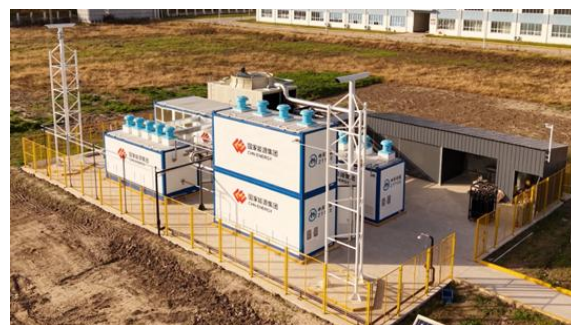
图：ALK 电解槽和可移动式撬装制氢设备
